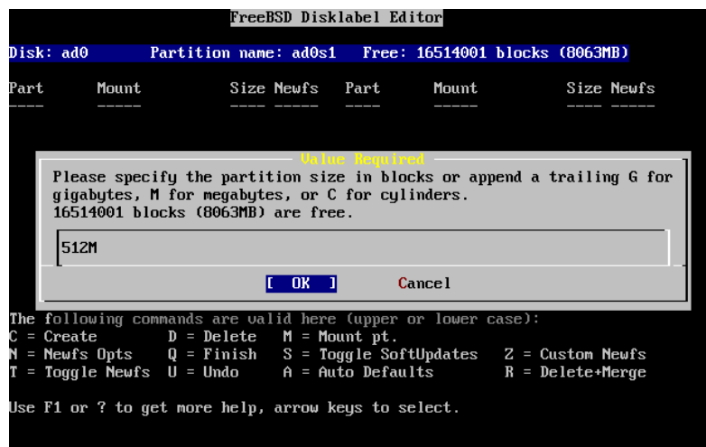
Rysunek 2-19. Zmiana rozmiaru głównej partycji
