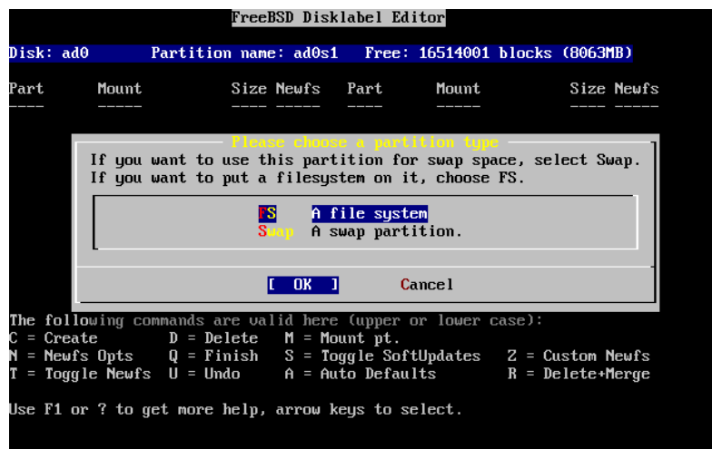
Figura 2-20. Scelta del Tipo della Partizione Root
