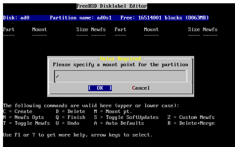
Figura 2-21. Scelta del Punto di Mount della Root
