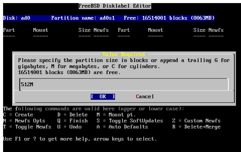
Figuur 2-21. Grootte van de rootpartitie wijzigen
