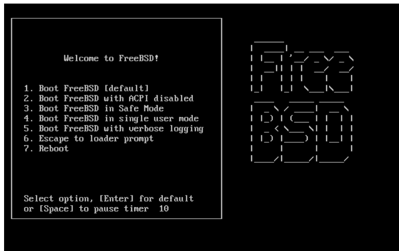
Figure 2-1. FreeBSD-ийн ачаалагч эхлүүлэгч цэс
